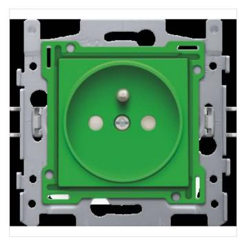
Prise de courant avec prise de terre et soupapes de sécurité, profondeur de montage 21 mm, socle et kit de finition, bornes à vis, vert
